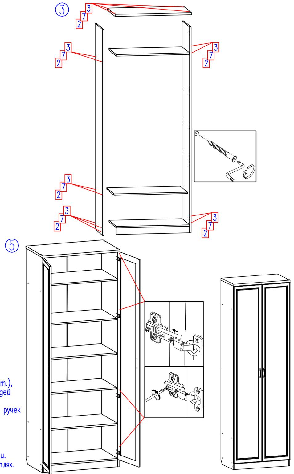
1. В деталях 1, 2 на посадочные места согласно схеме сборки установить монтажные планки (по 4 шт.), полкодержатели (по 6 шт.). На нижний торец установить подпятники (по 2 шт.) при помощи гвоздей и молотка.
